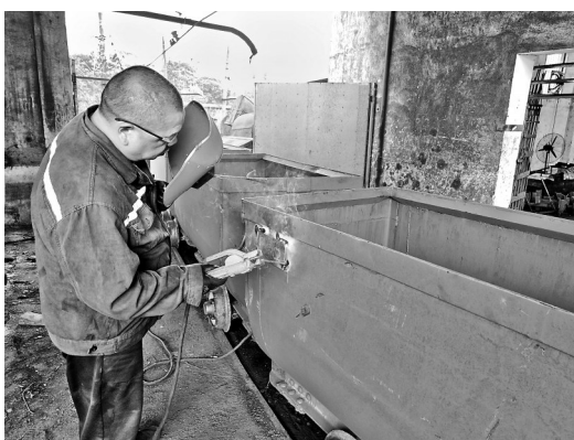
今年来,福建煤电公司龙潭煤矿对新购进的矿车实施统一编号,并建立信息管理系统,以加强矿车管理,实现对矿车运行状态的实时监控和数据统计,从而提升设备管理效率。图为3月17日,矿车修班维修工为矿车焊接“数字身份证”。(陈思忠 摄)
