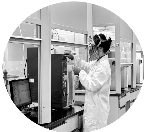
图为化验员张玉蓉正在进行油品馏程分析
