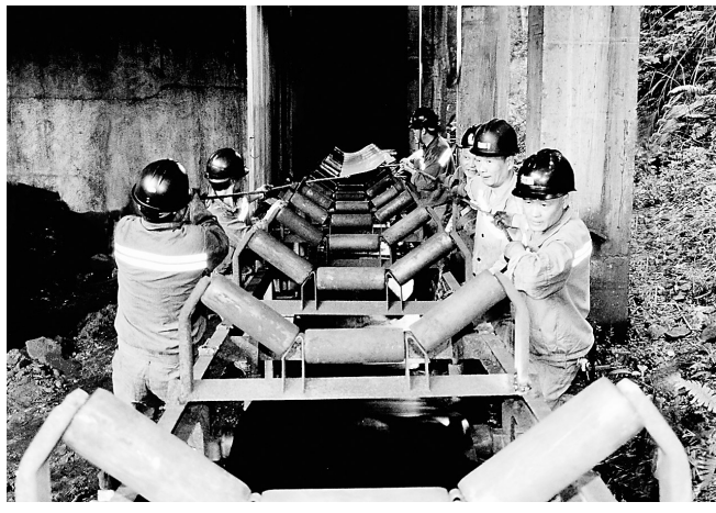
▲近期,永安煤业公司池坪芦坑煤矿对半煤岩筛选系统进行改造,以保证出井的半煤岩能够做到“应筛尽筛”。图为10月18日,该矿机运队职工在安装筛选系统皮带机的皮带。
