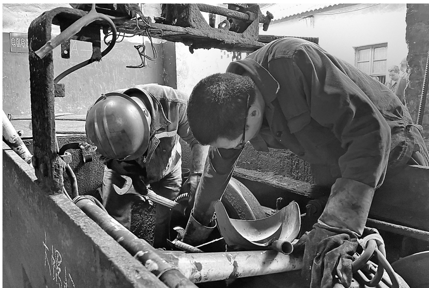
10月15日,福建煤电公司翠屏山煤矿机电队对机车大齿轮进行维检修。此次维检修旨在保证矿井运输设备的顺畅运行,提高生产效率,为矿井秋冬安全生产筑牢坚实基础。(郑薇摄)
