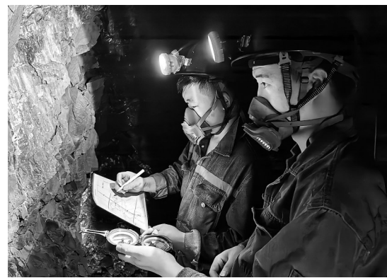
10月3日,福建煤电公司龙潭煤矿生产股地质技术员在井下工作面现场准确“把脉”,确定煤、岩层走向,为煤矿的开采布局提供基础地质资料。(陈思忠 摄)
