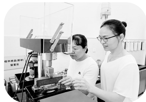
图为卓盆花(右)在公司实验室指导技术员水泥混凝土抗折实验
