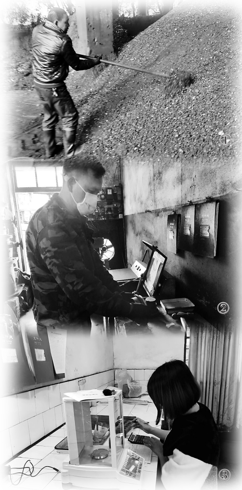
①上图为采样工在煤堆上进行采样操作 ②中图为制样员研磨煤样后进行装袋 ③下图为化验员在测算化验数据
