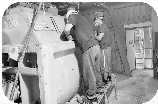
“双节”期间，建材控股龙岩混凝土公司机修班组坚守岗位、奋战在一线，保障生产的正常运行。图为机修班组成员正在更换搅拌机检修门的密封条。（曾毓忠 摄）
