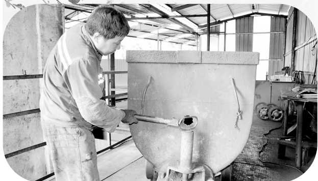
“双节”期间，因生产需要，永安煤业公司池坪芦坑煤矿职工默默坚守在各自的岗位上。图为该矿机运队职工在维修旧矿车。（陈思洲 摄）
