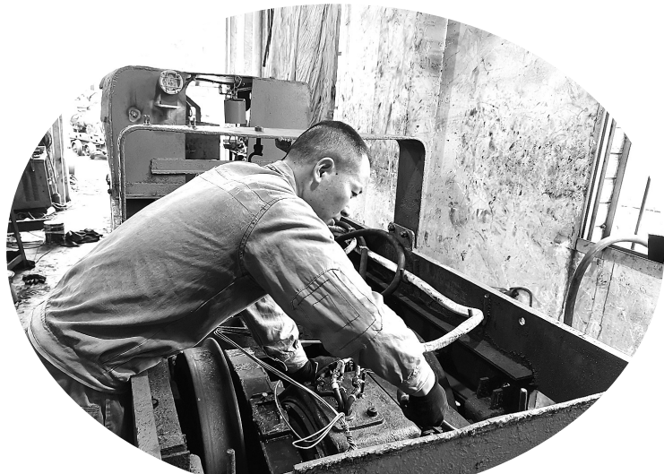
▲为进一步做好节支降耗工作，建设节约型矿井，永安煤业公司苏桥煤矿机运队坚持“能修复绝不报废、能利用绝不买新”的原则，组织电工班人员对出现故障的架线电机车进行维修保养，确保材料运输、车皮供应正常，为井下生产一线提供强有力的后勤服务保障。图为近日，电工班人员正在维修保养架线电机车。（郑震恺 摄）
