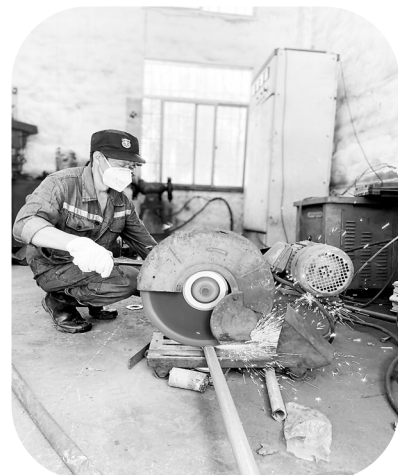
图为曾基才正在对拆下的旧水管进行切割
